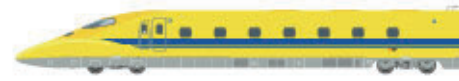
923形 ドクターイエロー 【Class 923 Dr.Yellow】 新幹線電気軌道総合試験車
